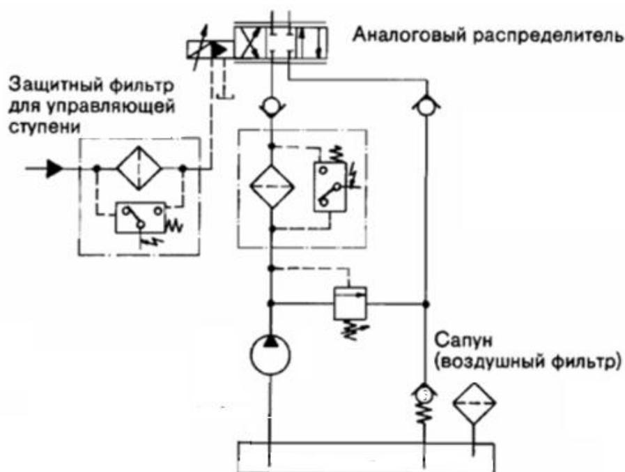
Рис. 4.54. Концепция фильтрации в крупной гидросистеме
