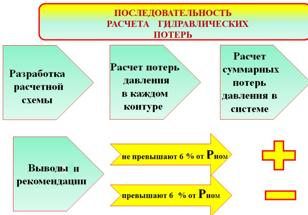
Рис. 5.1. Рекомендуемая последовательность расчета гидравлических потерь
