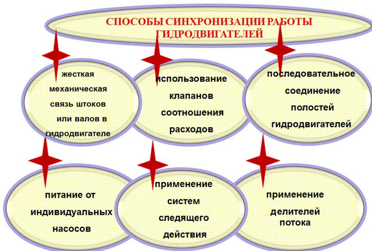
Рис. 2.20. Способы синхронизации движения гидродвигателей
