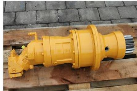
Рис. 1.6. Мотор-редукторы поворота платформ, башен
