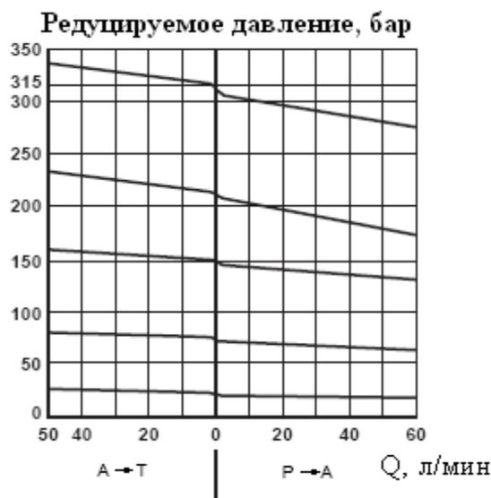
Рис. 4.35. Гидравлические характеристики редукционного клапана прямого действия
