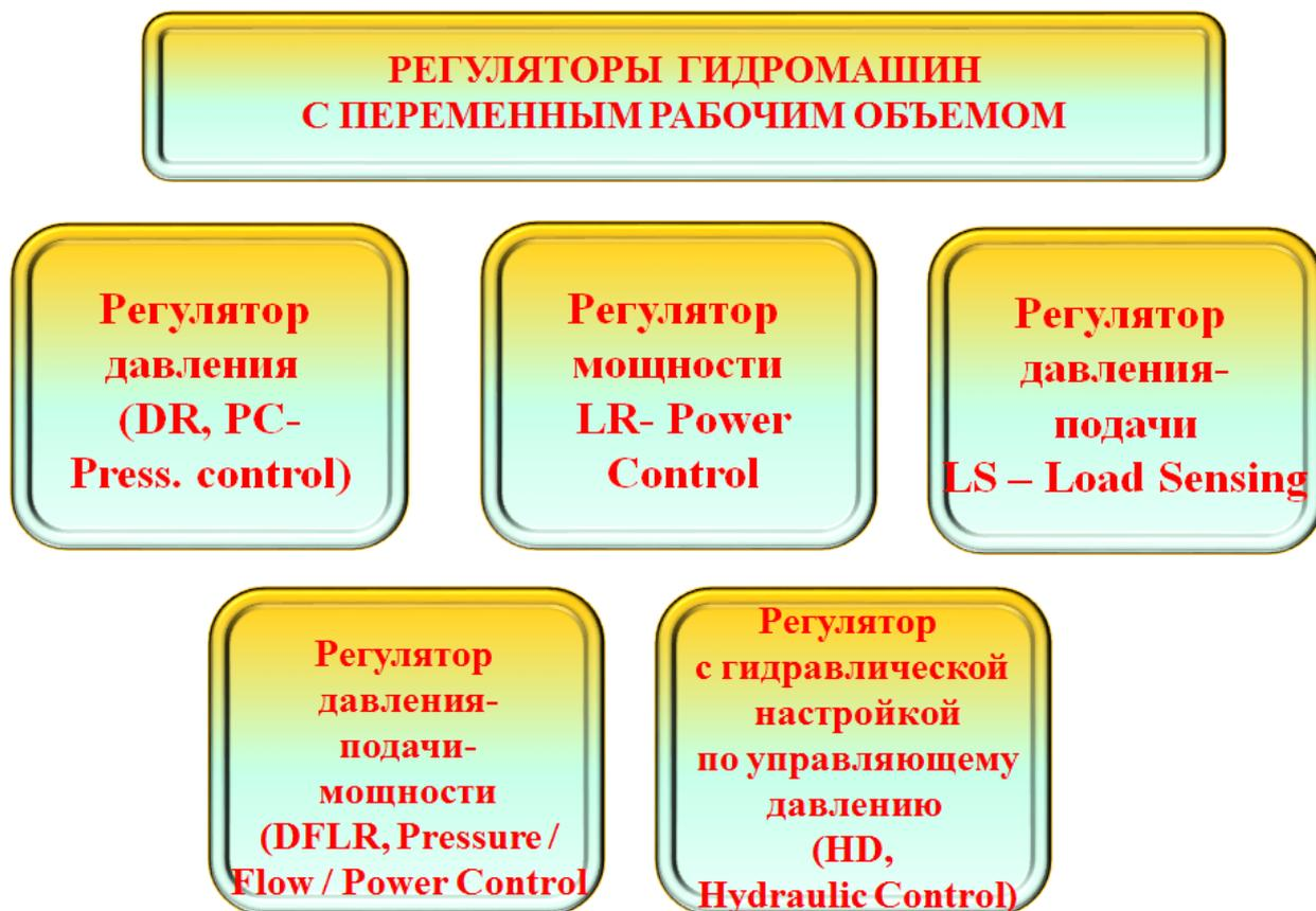
Рис. 2.47. Классификация регуляторов гидромашин с контролем нагрузки
