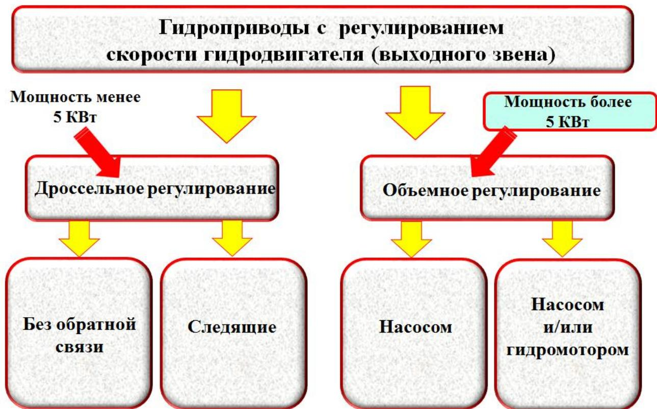
Рис. 2.29. Способы регулирования гидропривода
