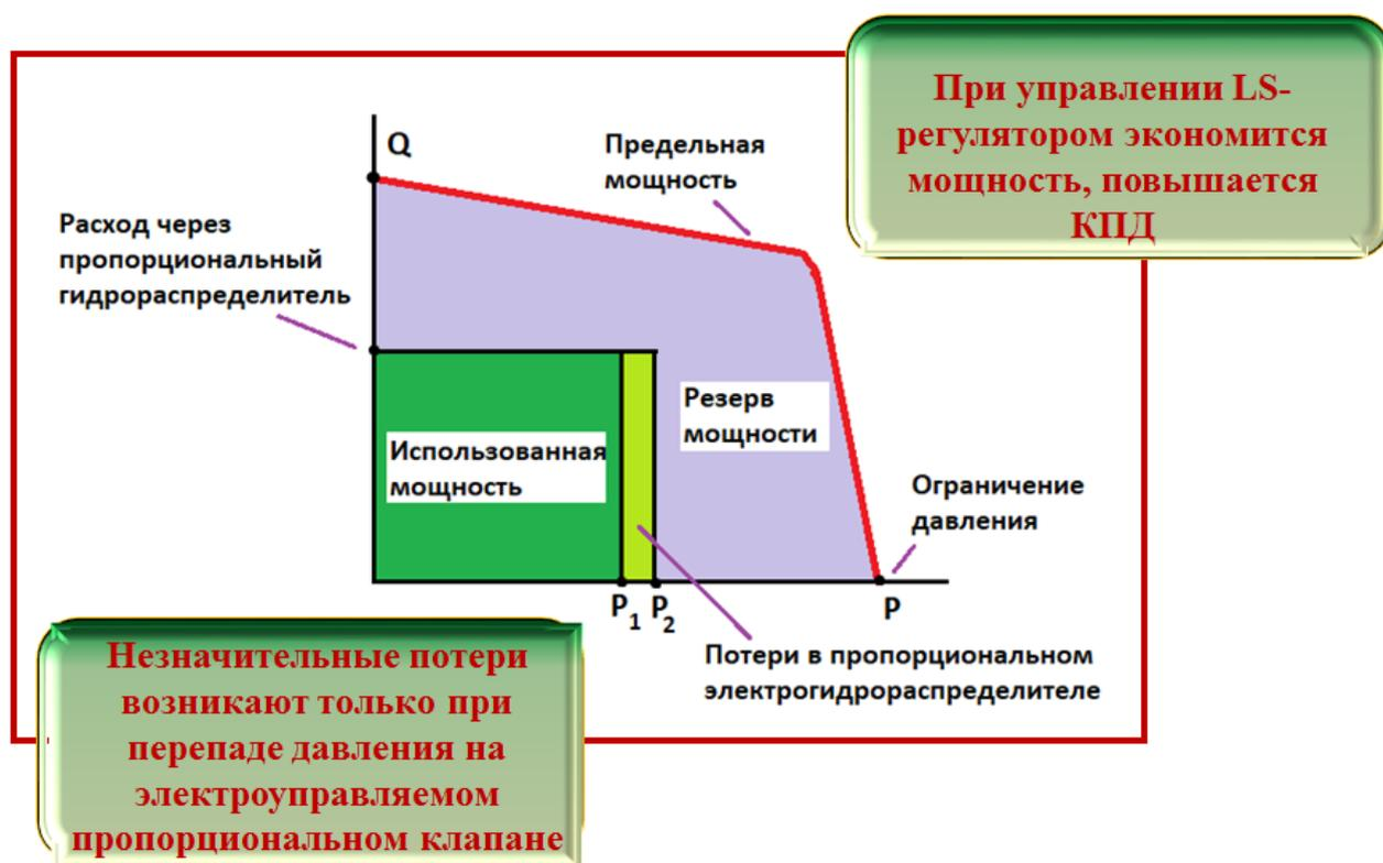
Рис. 2.60. Распределение мощности в насосе с LS-регулятором
