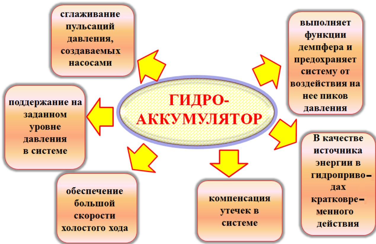
Рис. 2.24. Функции гидроаккумулятора
