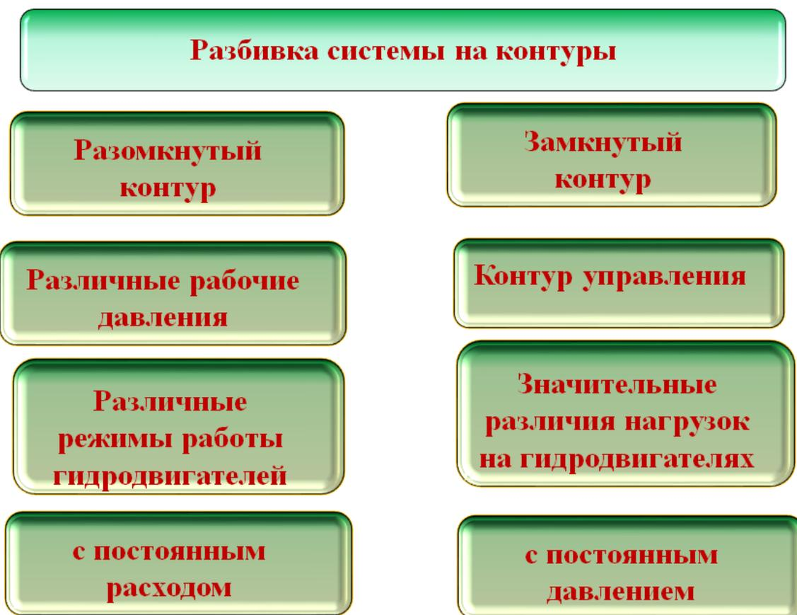
*Рис. 2.70.* Особенности выбора вида контуров гидросистемы
