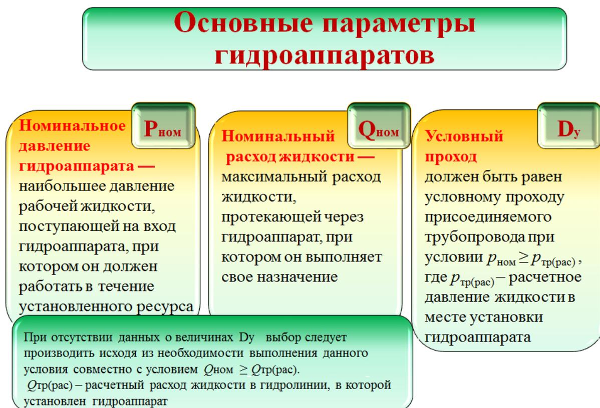
Рис. 4.2. Основные параметры гидроаппаратуры
