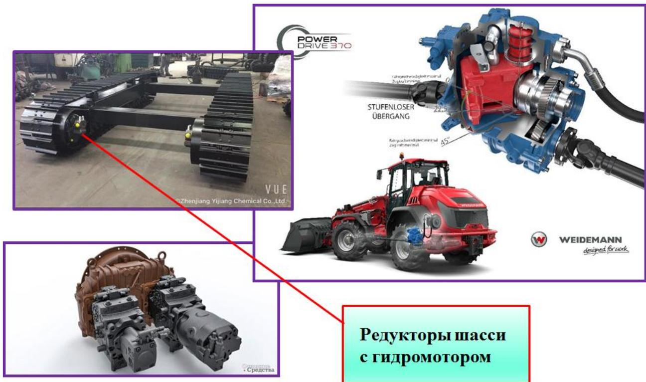
Рис. 1.8. Мотор-редукторы привода шасси
