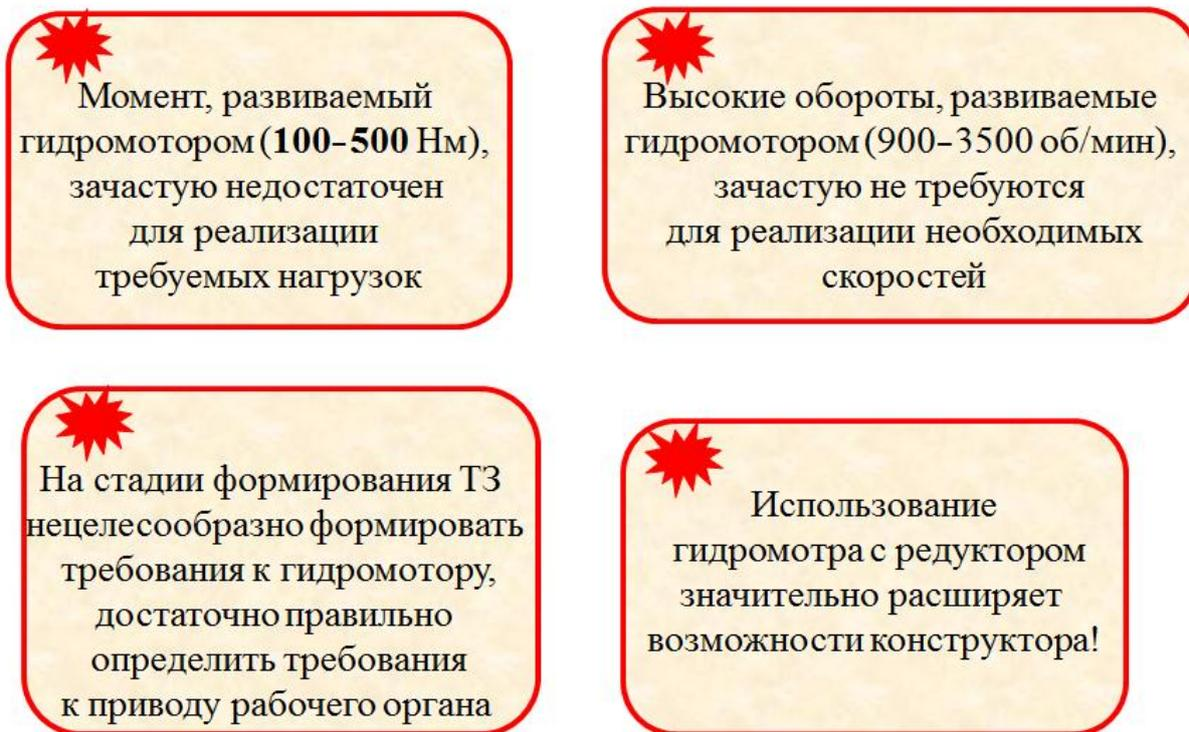
Рис. 1.5. Момент и частота вращения исполнительного органа
