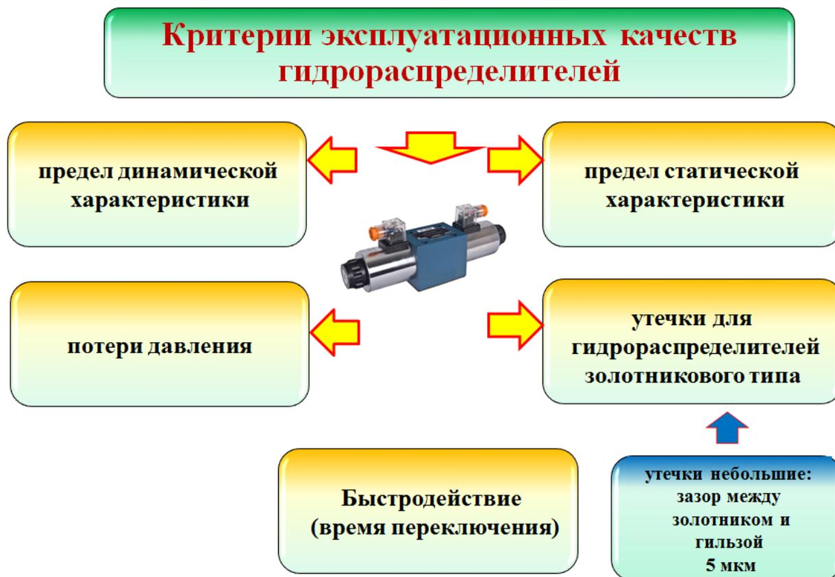
Рис. 4.6. Эксплуатационные качества гидрораспределителей
